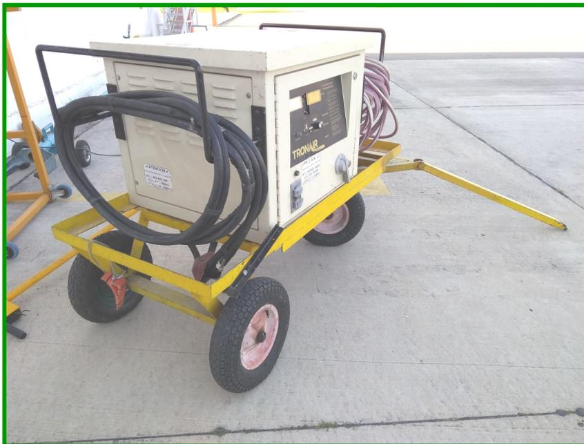
Dicho carro, posee una lanza que gira con las ruedas delanteras, utilizándose como “freno” al ser colocada a 90° del carro.
